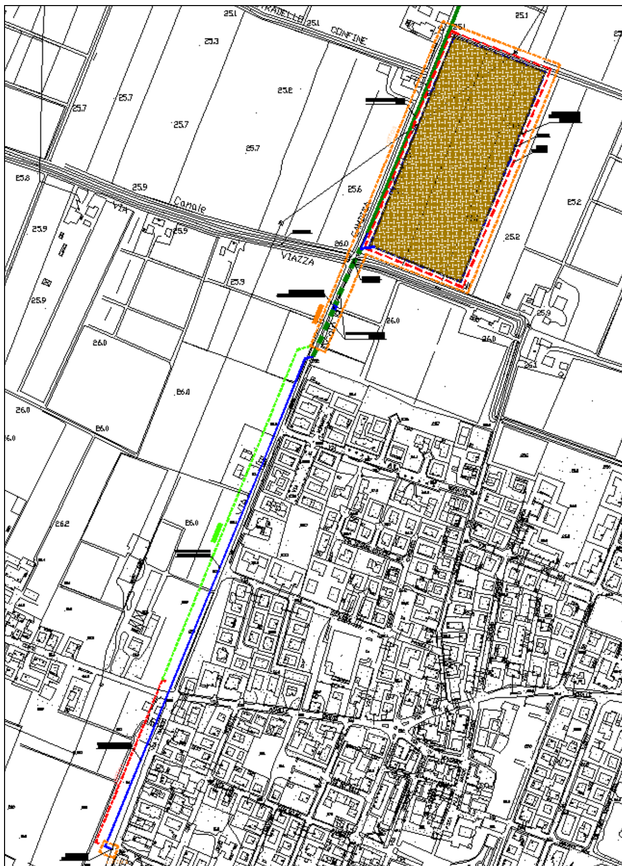
Figura 1 – Interventi di riequilibrio idraulico sul reticolo idrografico superficiale e fognario della porzione Ovest di bacino urbano dell'agglomerato "Capoluogo" del Comune di Soliera (MO). Suddivisione delle opere in lotti funzionali.
